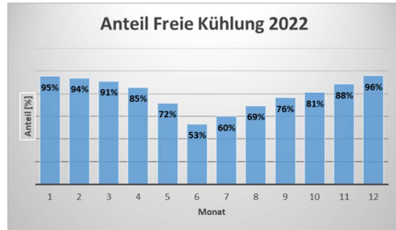
Abbildung 7: Anteil der freien Kühlung in 2022
