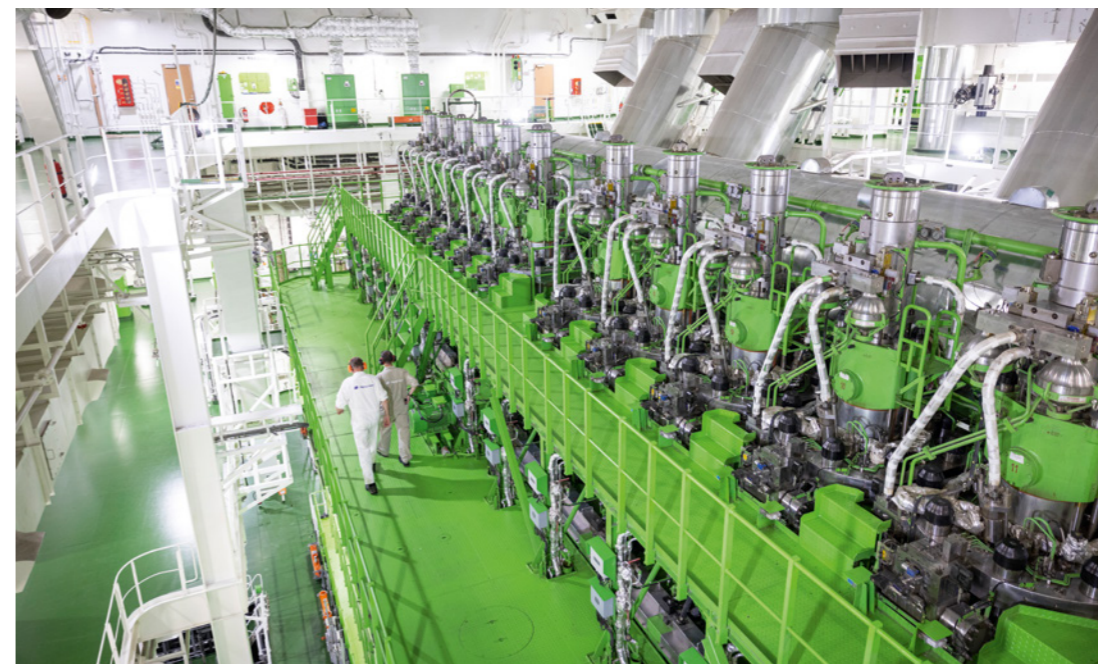
Der Everllence B&W ME-GI Dual-Fuel-Zweitaktmotor kann mit Schiffskraftstoff, Flüssigerdgas, Biomethan und synthetisches Erdgas betrieben werden.
