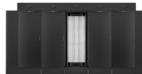
Rendering des HPE Cray Supercomputing GX5000. Die Direktflüssigkeitskühlungstechnologie von HPE sorgt für effiziente und sichere Betriebsbedingungen für die leistungsstarken Prozessoren von AMD. Bild mit Genehmigung von HPE.
