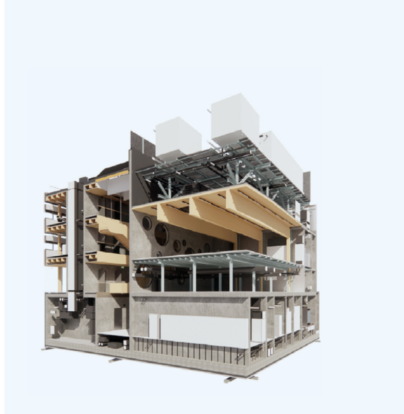
Abbildung 2: Der Schnitt durch das geplante Gebäude zeigt die tragende Funktion von Holz (Visualisierung: Benthem Crouwel | Birk Heilmeyer und Frenzel)
